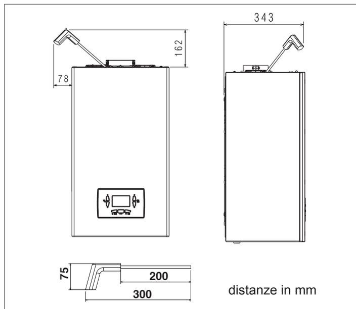
⚠ In caso di installazione dei modelli **PRINCE CX 50DEP-50** è **INDISPENSABILE** prevedere gli spazi necessari per l'introduzione dello strumento per l'analisi comburionale. Riportiamo un disegno campione dove le distanze tra caldaia e pensile/nicchia sono state ottenute utilizzando uno strumento di lunghezza 300 mm. Strumenti di lunghezze superiori necessitano di spazi maggiori.
