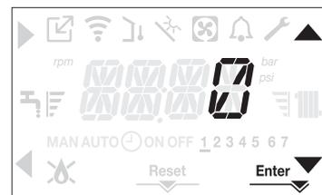
Tutte le volte che la caldaia è alimentata elettricamente viene eseguito un ciclo di sfiato della durata di 6 min.
