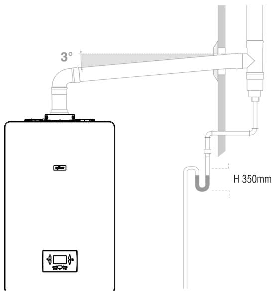
Per i cambi di direzione utilizzare un raccordo a T con tappo di ispezione il quale permette una facile pulizia periodica delle tubature. Accertarsi sempre che dopo la pulizia i tappi di ispezione vengano richiusi ermeticamente con la relativa guarnizione integra.
