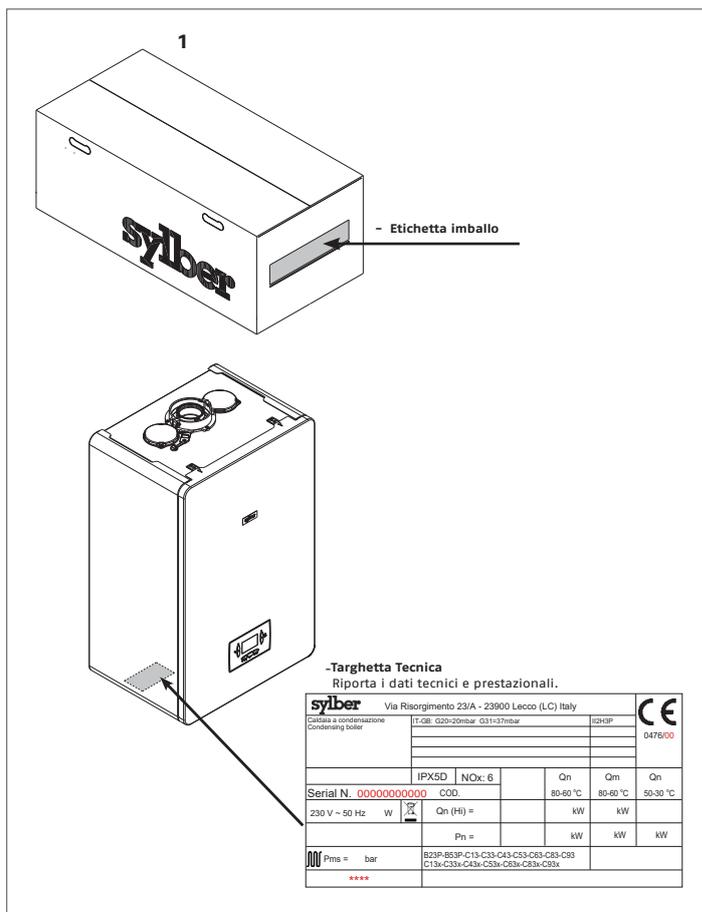
**!** La manomissione, l'asportazione, la mancanza della Targhetta Tecnica o quant'altro non permetta la sicura identificazione del prodotto, rende difficoltosa qualsiasi operazione di installazione e manutenzione.
