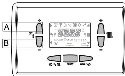
La successiva pressione dei tasti A o B consente di impostare il valore del setpoint sanitario incrementandolo o decrementandolo all'interno del range prestabilito, con step di 0,5°C. Le barre di livello a fianco dell'icona riscaldamento mostrano il valore di setpoint impostato rispetto al range di funzionamento:
