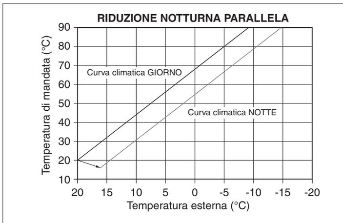
L'utente può indirettamente intervenire sul valore di setpoint RISCALDAMENTO andando ancora una volta ad introdurre, sul valore di temperatura di riferimento GIORNO (20°C) piuttosto che NOTTE (16°C), un offset che può variare all'interno del range [-5 ÷ +5]. Per la correzione dell'offset fare riferimento al paragrafo "3.8 Regolazione della temperatura acqua di riscaldamento con sonda esterna collegata".
