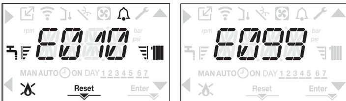
⚠ Se i tentativi di ripristino non attiveranno il funzionamento della caldaia, interpellare il Centro di Assistenza Tecnica.
