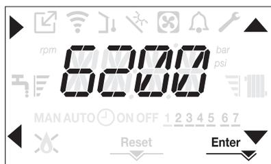
Una volta impostata la potenza desiderata (massimo riscaldamento) riportare il valore sull'etichetta riportata sul retro copertina del presente manuale. Per successivi controlli e regolazioni riferirsi al valore impostato.
