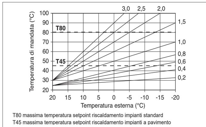
T80 massima temperatura setpoint riscaldamento impianti standard
