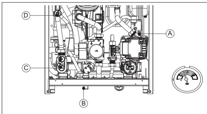
NOTA: le operazioni di riempimento dell'impianto devono essere fatte agendo sul rubinetto di riempimento (B) con caldaia in stato OFF.
