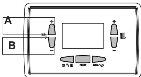
La successiva pressione dei tasti **A** o **B** consente di impostare il valore del setpoint sanitario incrementandolo o decrementandolo all'interno del range prestabilito, con step di 0,5°C.
