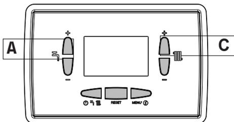
Tutte le volte che la caldaia è alimentata viene eseguito un ciclo di sfiato della durata di 6 min. Il display visualizza -AIR e si accende l'icona RESET.
