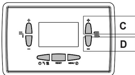
La successiva pressione del tasto **C** oppure **D** consente di impostare il valore del setpoint riscaldamento all'interno del range prestabilito:
