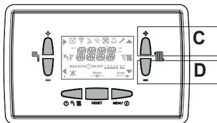
La successiva pressione del tasto **C** oppure **D** consente di impostare il valore del setpoint riscaldamento all'interno del range prestabilito:
