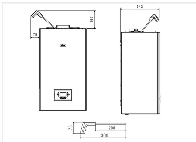
**!** In caso di installazione è **INDISPENSABILE** prevedere gli spazi necessari per l'introduzione dello strumento per l'analisi combustione. Riportiamo un disegno campione dove le distanze tra caldaia e pensile/nichia sono state ottenute utilizzando uno strumento di lunghezza 300 mm. Strumenti di lunghezze superiori necessitano di spazi maggiori.
