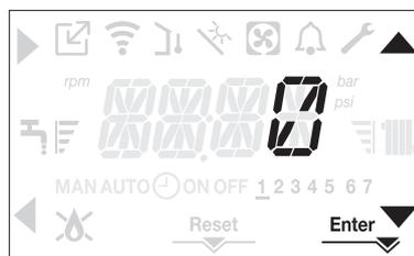
Tutte le volte che la caldaia è alimentata viene eseguito un ciclo di sfiato della durata di 4 min. Il display visualizza -AIR e si accende l'icona RESET.
