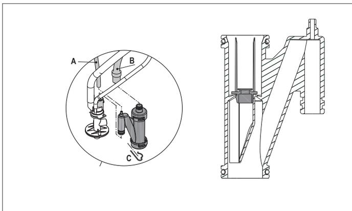
**⚠** In caso di inutilizzo dell'apparecchio per più di 60 giorni, è necessario provvedere al riempimento del sifone in caldaia. Se la caldaia è installata ove la temperatura ambiente può rimanere per prolungati periodi sopra i 30°C, riempire il sifone dopo un periodo di 30 giorni di inutilizzo. L'operazione deve essere effettuata da personale professionalmente qualificato.
