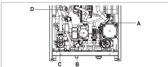
NOTA: le operazioni di riempimento dell'impianto devono essere fatte agendo sul rubinetto di riempimento (B) con caldaia in stato OFF.
