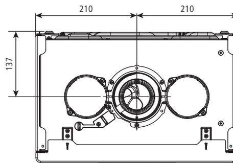
Prevedere un'inclinazione del condotto scarico fumi di 3° verso la caldaia.
