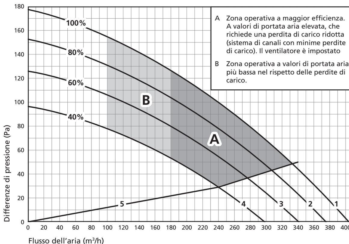
NOTA: le curve ridotte montate sull'aspirazione e sulla mandata dell'aria, perdono 4 Pa ciascuna. Le macchine escono dalla fabbrica settate sulla curva 3.
