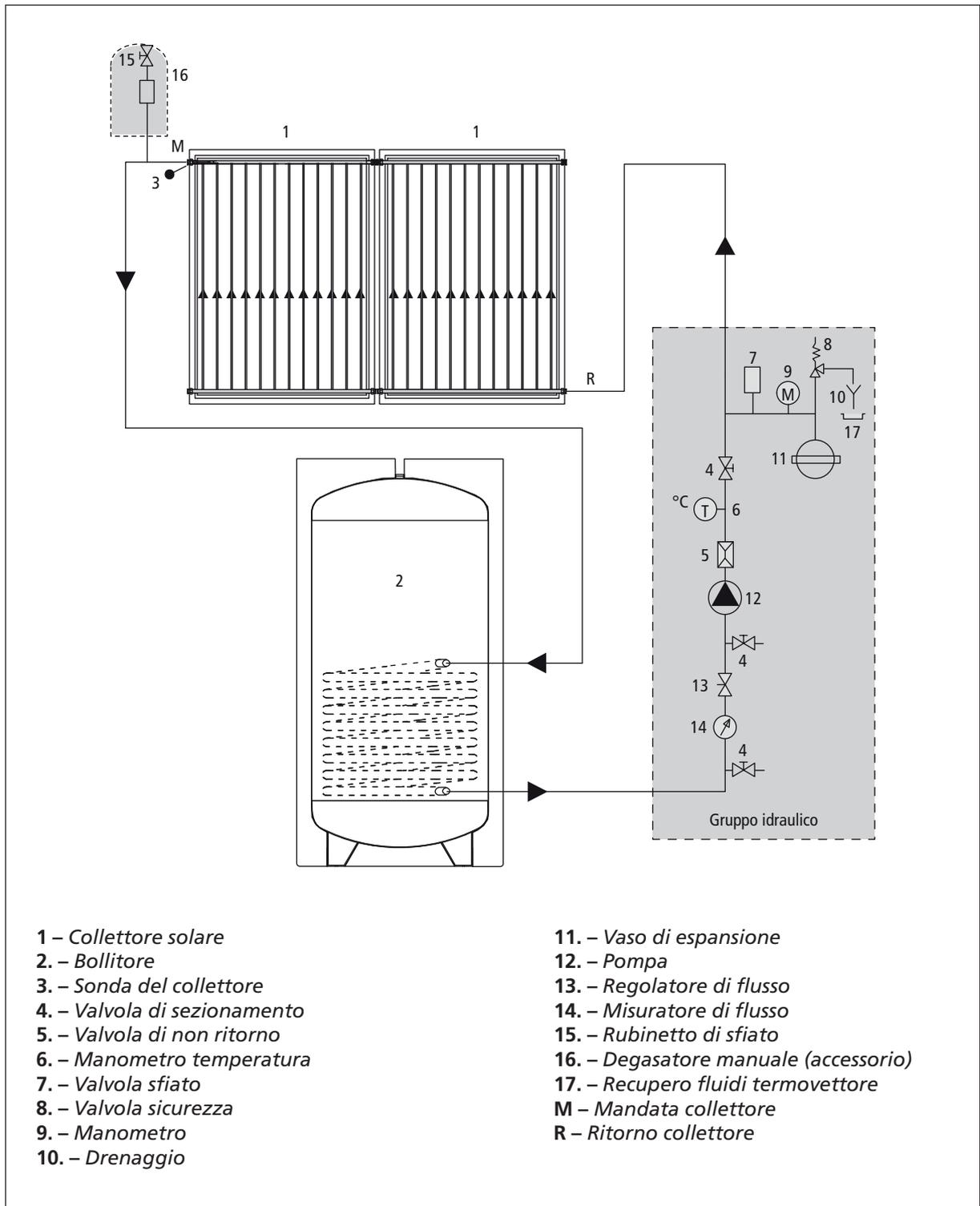
Si consiglia di utilizzare tubazioni in acciaio INOX predisposte per il solare (mandata, ritorno e tubo per la sonda).
