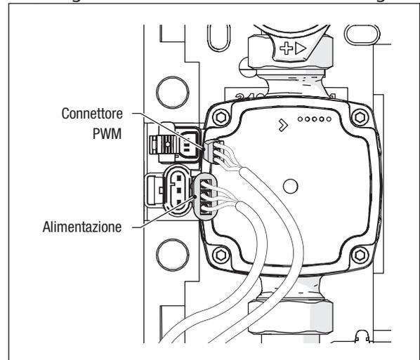
Nel caso si voglia controllare il circolatore in modalità ON/ OFF non è richiesto l'utilizzo del cavo PWM. Nel caso si voglia controllare il circolatore in modalità modulante tramite un regolatore solare, verificare la compatibilità del regolatore scelto con le caratteristiche del segnale PWM (vedere paragrafo "SEGNALI DI CONTROLLO" di seguito).
