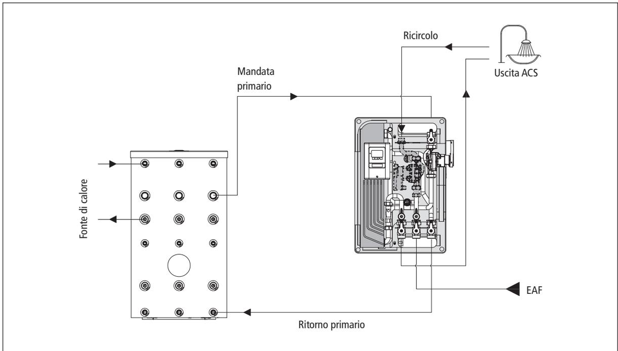
Il modulo deve essere posizionato in prossimità dell'accumulo. Il sistema è dimensionato per una lunghezza delle tubazioni di collegamento tra modulo e bollitore pari a 4 metri (andata + ritorno). In caso di ricircolo prevedere un vaso di espansione opportunamente dimensionato al fine di evitare sovrappressioni dovute a dilatazioni termiche e colpo d'ariete.
