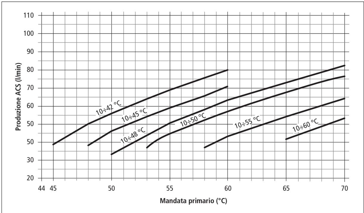
Il corretto funzionamento del modulo è garantito se la temperatura di mandata del circuito primario supera di almeno 5°C la temperatura di set ACS impostata.
