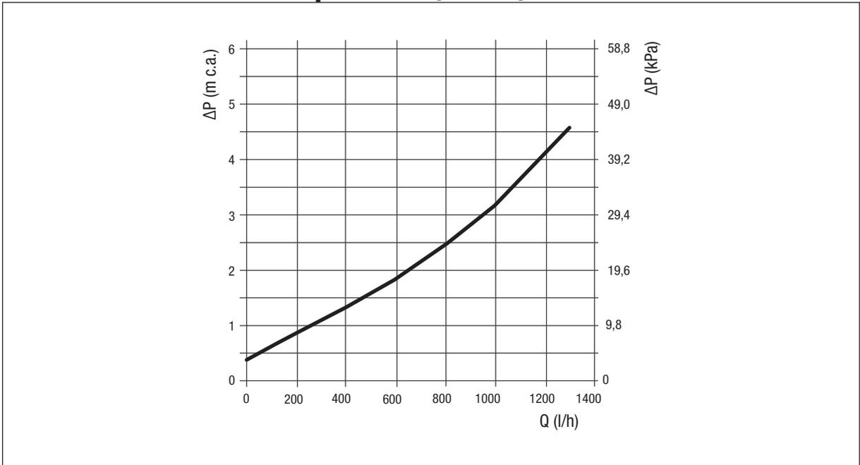
Per ricavare la prevalenza utile, sottrarre il valore di perdita di carico a quello di prevalenza letto nel diagramma del circolatore solare qui di seguito.
