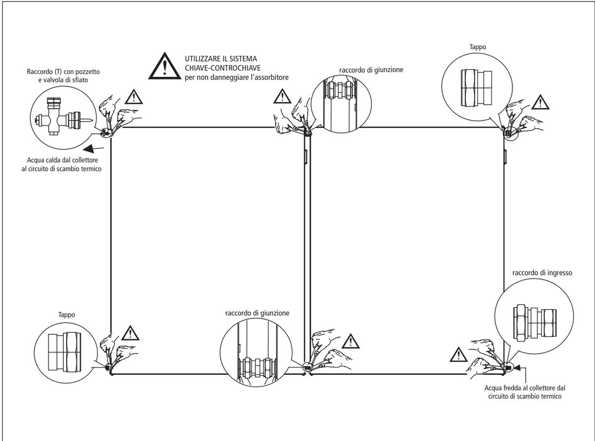
I collettori vengono collegati tra loro in modo che il fluido termovettore li attraversi in parallelo. Il collegamento con il bollitore solare deve essere realizzato in corrispondenza del pozzetto della sonda (T), sull'ultimo collettore della serie (vedere figura). Il posizionamento del pozzetto sul collettore permette il massimo trasferimento del calore accumulato nei pannelli.
