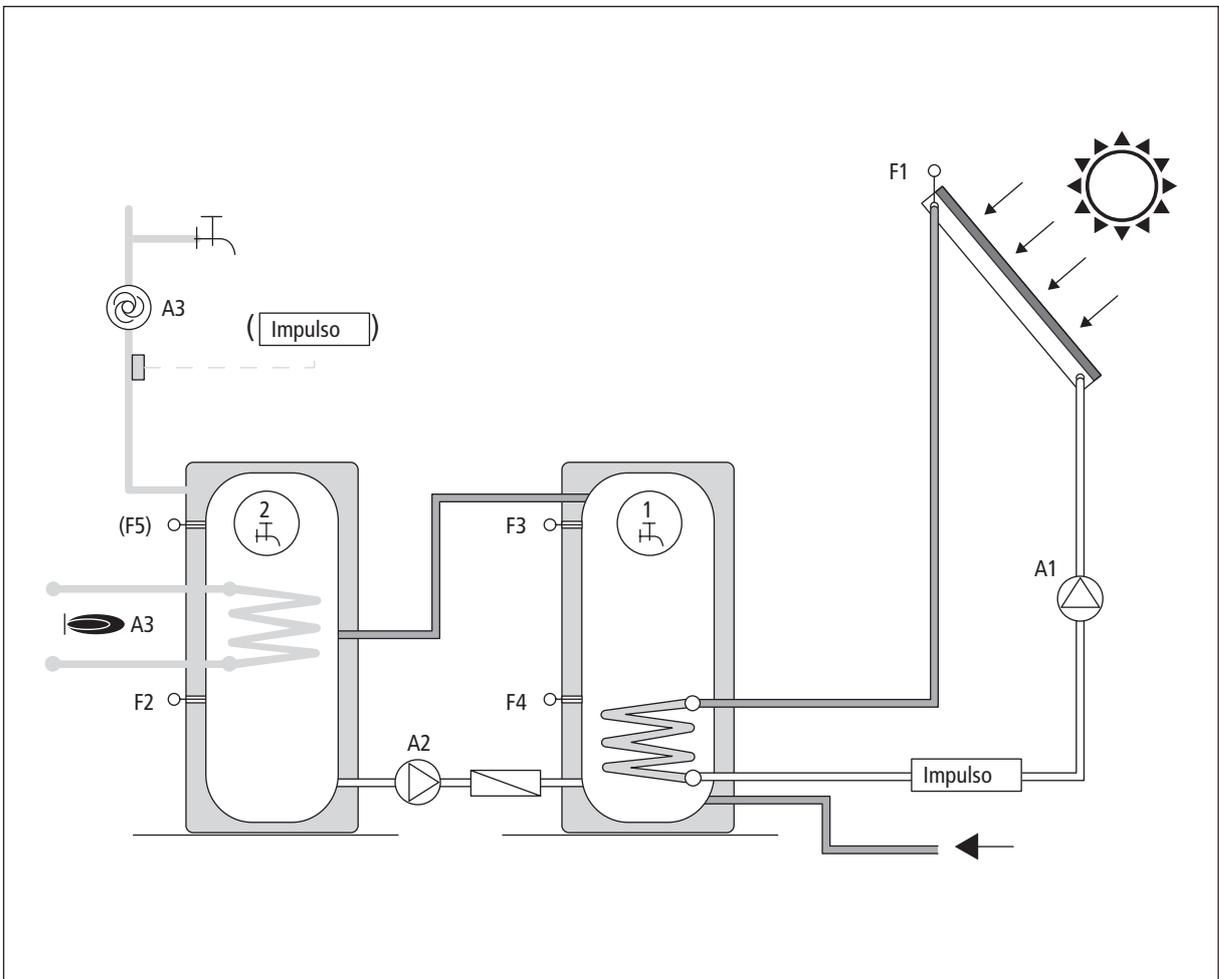
**Impianto 11 - Regolazione solare con controllo di due zone di stratificazione del bollitore (SUN C)**
