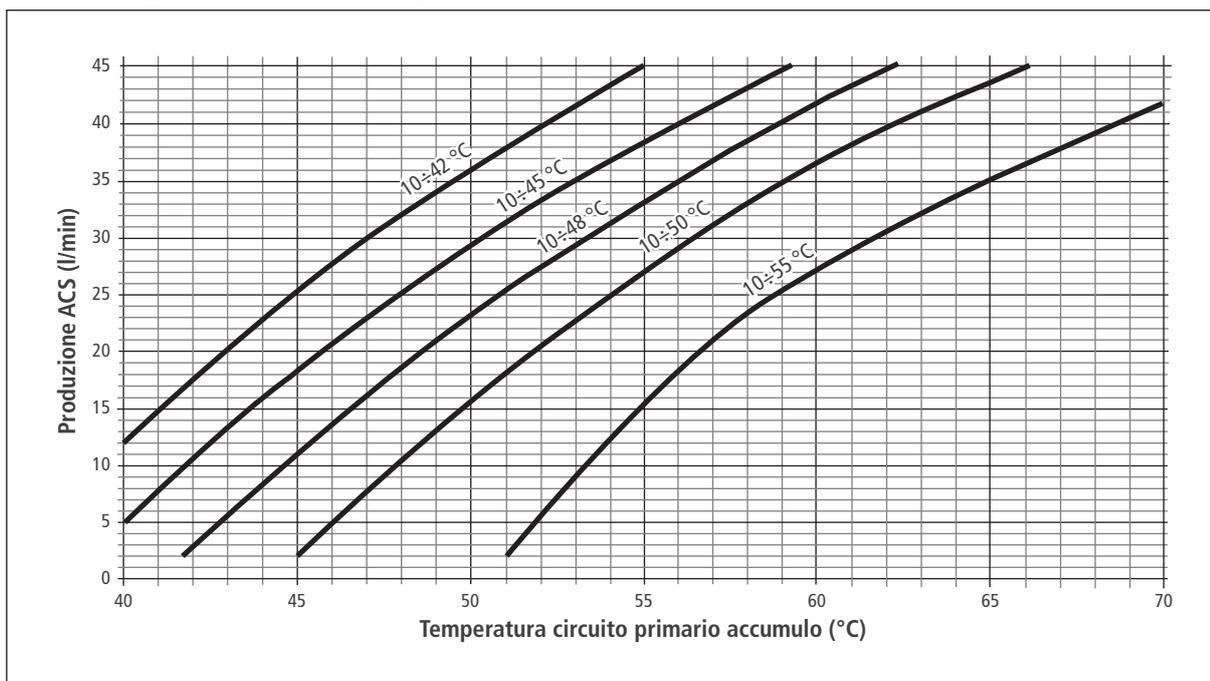
Il corretto funzionamento del modulo è garantito se la temperatura di mandata del circuito primario supera di almeno 5K la temperatura di set ACS impostata.
