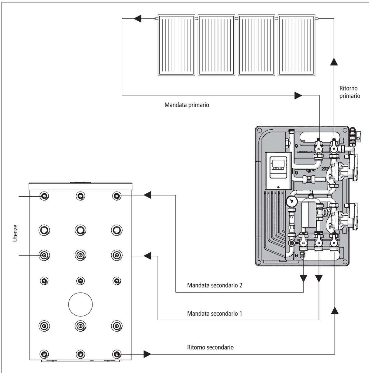
Il modulo deve essere posizionato in prossimità dell'accumolo. Il sistema è dimensionato per una lunghezza delle tubazioni di collegamento tra modulo e bollitore pari a 4 metri (andata + ritorno).
