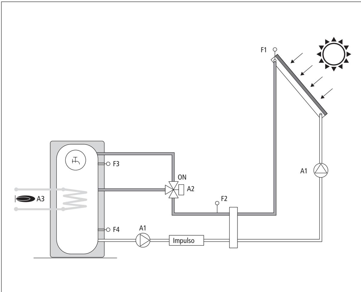
**Impianto 12 - Regolazione solare con controllo di tre zone di stratificazione del bollitore (SUN C)**
