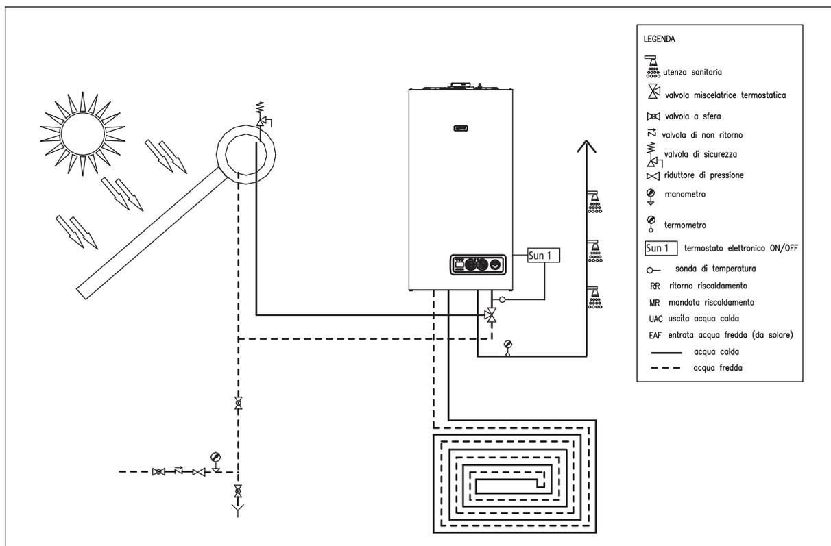
Nello schema sopra riportato è rappresentato un impianto di produzione ACS con caldaia combinata Linea Condensing in cascata al bollitore con impianto solare a circolazione naturale.
