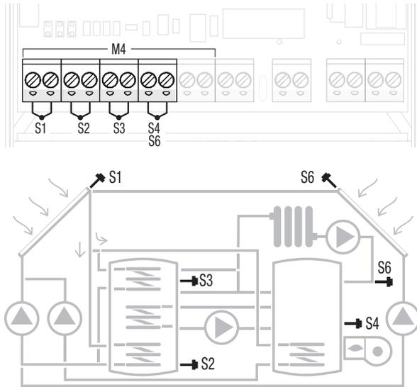
Le sonde di temperatura allacciate possono essere controllate con un multimetro-tester. La corrispondenza tra temperatura e resistenza è indicata nelle tabelle seguenti.
