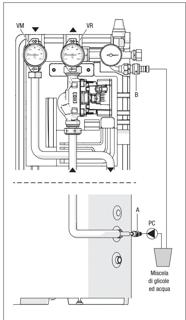
La pressione impostata deve essere tale da garantire che quella misurata ai collettori solari sia positiva rispetto l'ambiente (evitare che il campo solare sia in depressione), e deve tenere in considerazione sia la pressione di apertura della valvola di sicurezza (6 bar) che quella di precarica del vaso di espansione solare. Per la corretta impostazione della pressione dell'impianto fare riferimento al manuale di progettazione.
