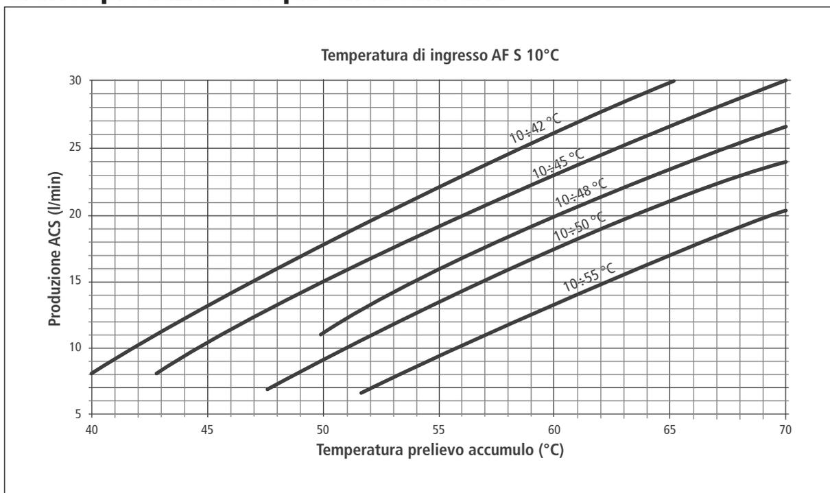
Il corretto funzionamento del modulo è garantito se la temperatura di mandata del circuito primario supera di almeno 5K la temperatura di set ACS impostata.
