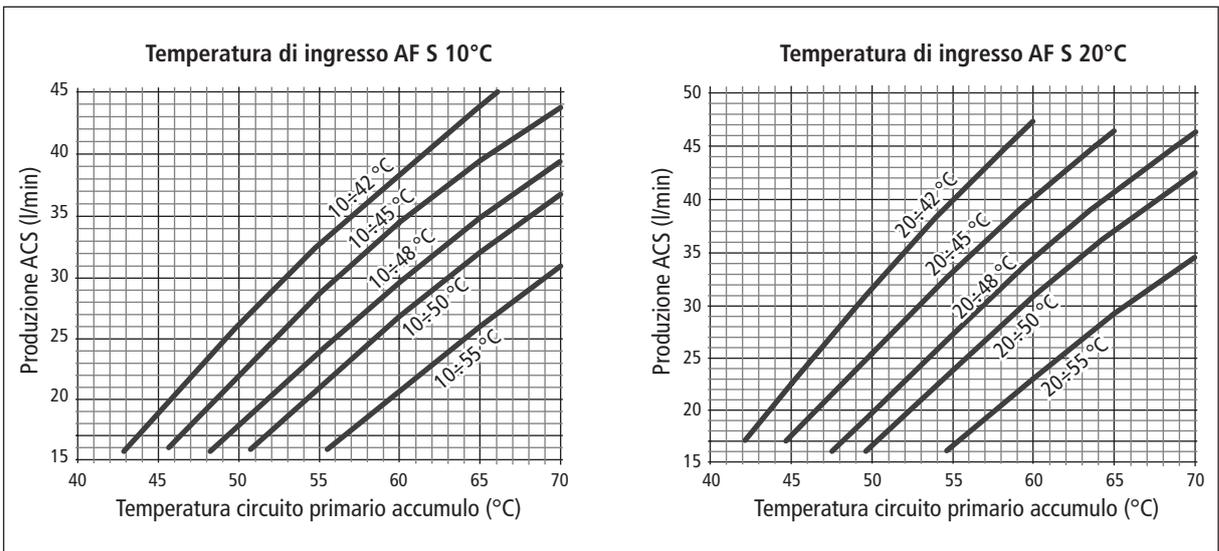
Il corretto funzionamento del modulo è garantito se la temperatura di mandata del circuito primario supera di almeno 5K la temperatura di set ACS impostata.
