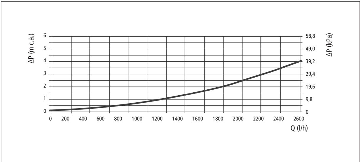
Per ricavare la prevalenza utile, sottrarre il valore di perdita di carico a quello di prevalenza letto nel diagramma del circolatore solare qui di seguito.
