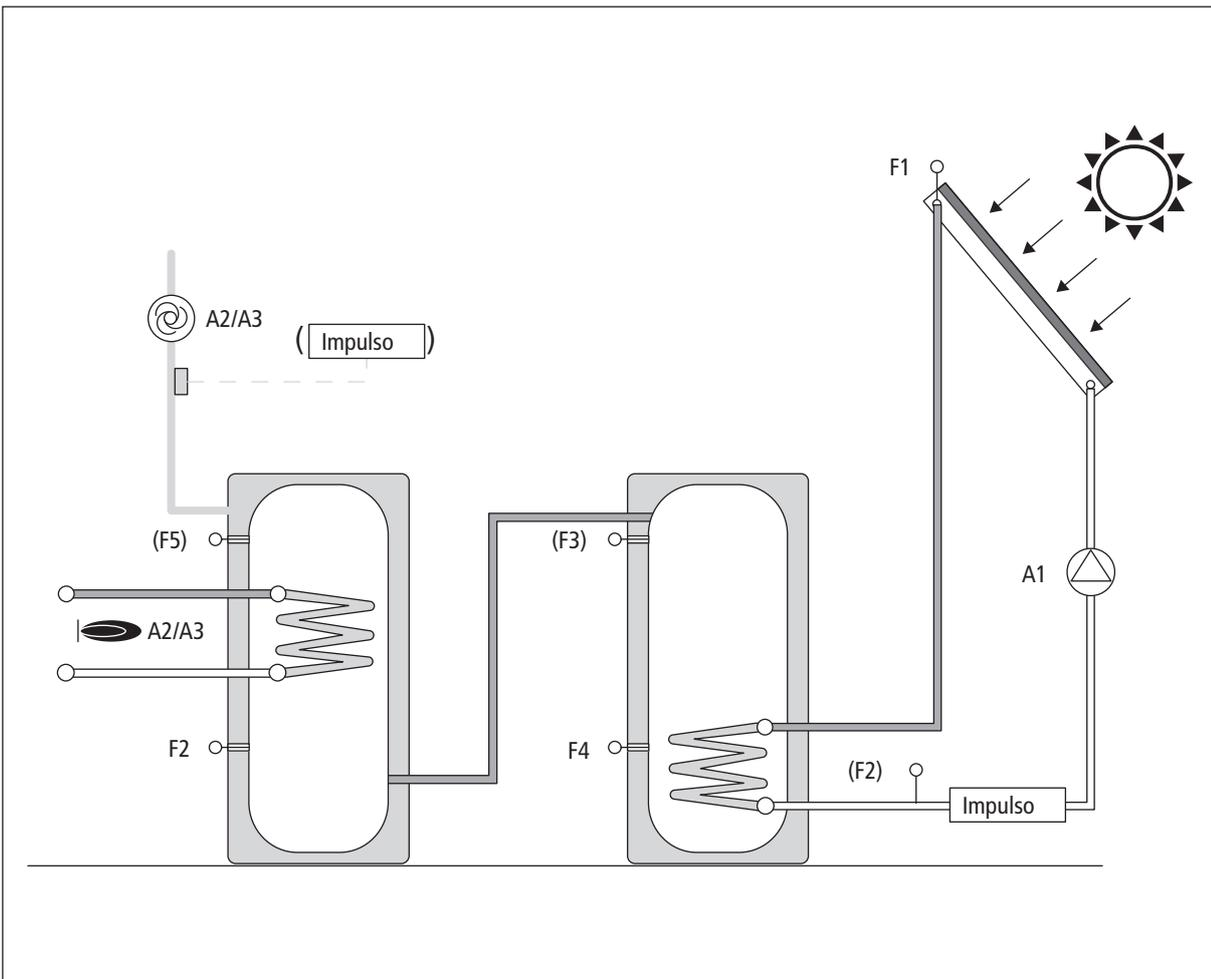
**Impianto 8 - Regolazione solare con controllo della temperatura di ritorno impianto**
