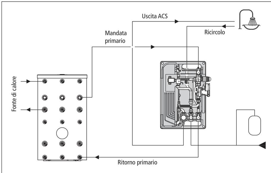
Il modulo deve essere posizionato in prossimità dell'accumulo. Il sistema è dimensionato per una lunghezza delle tubazioni di collegamento tra modulo e bollitore pari a 4 metri (andata + ritorno).
