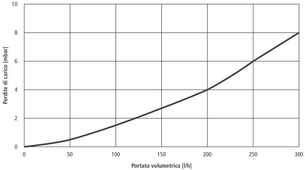
**Perdite di carico singolo pannello [33,3% glicole] - CFS-25/4 A**
