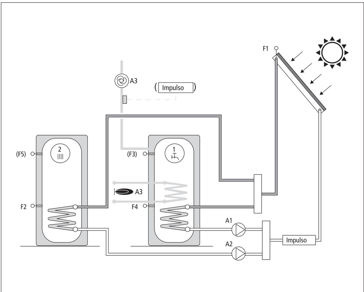
**Impianto 7 - Regolazione solare con funzione di riscaldamento supplementare**
