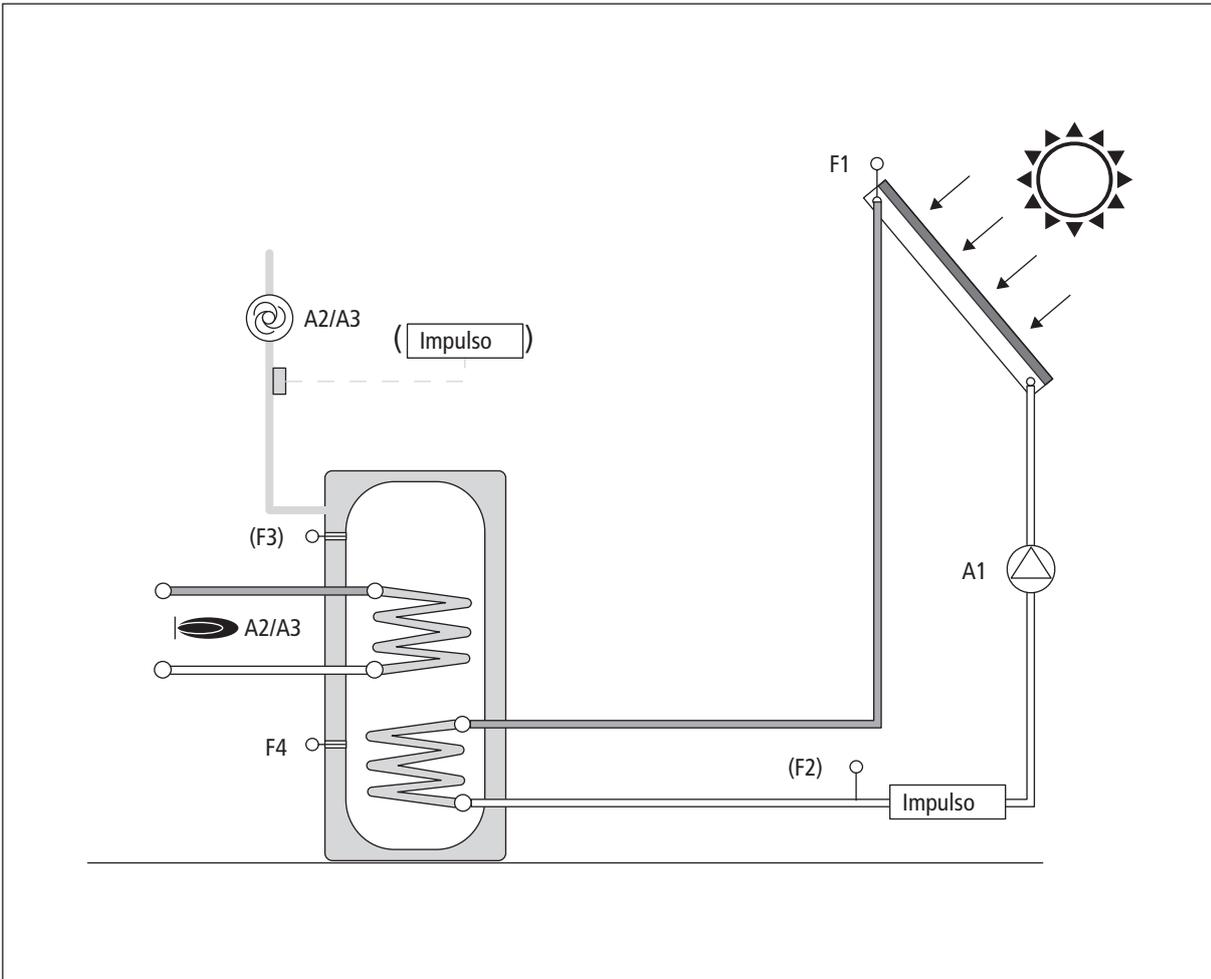
**Impianto 7 (variante) - Regolazione solare con funzione di riscaldamento supplementare**
